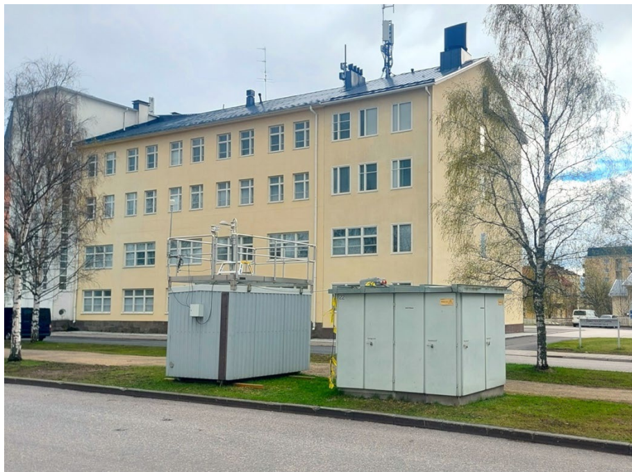
Kuva 17. Ilmanlaadun mittausasema Kemin keskustassa kuvassa oleva vasemman puoleinen harmaa kontti, jossa on turvakaiteet katolla.. Ulkoilma imetään mittalaitteisiin kontin katolla sijaitsevien näytteenottimien läpi. Lisäksi katolla on säämittausanturi. Valokuva: Matias Saunamäki & Mika Vestenius.
