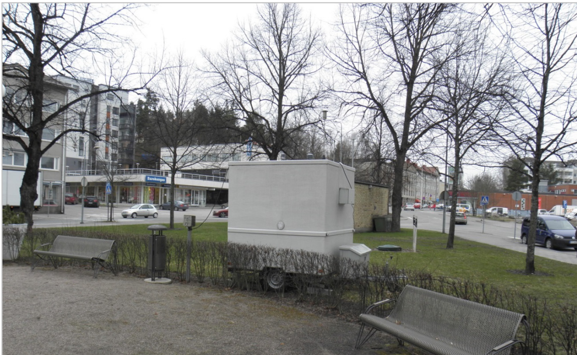
Kuva 3. Hiukkasmittausyksikkö Riihimäen Kolmiopuistossa. Ulkoilma imetään mittauslaitteeseen mittausyksikön katolla sijaitsevan näytteenottosondin kautta. Kuva: Helena Saari.
