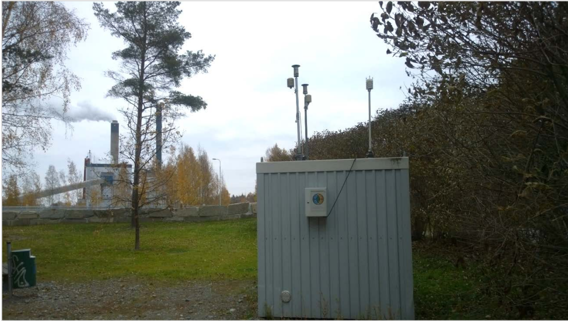
Kuva 4. Naistenlahden ilmanlaadun mittausasema Tunturipuistossa, lokakuussa 2016. Ulkoilma imetään mittauslaitteisiin mittausaseman katolla sijaitsevien näytteenot-tosondien kautta. Kuva: Jatta Salmi, Ilmatieteen laitos.
