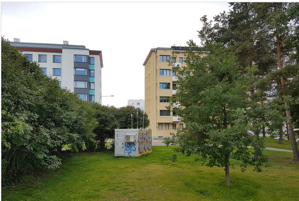
Kuva 41. Naistenlahden ilmanlaadun mittausasema Tunturipuistossa, syyskuussa 2017. Ulkoilma imetään mittauslaitteisiin mittausaseman katolla sijaitsevien näytteenotto sondien kautta. Kuva: Jatta Salmi.
