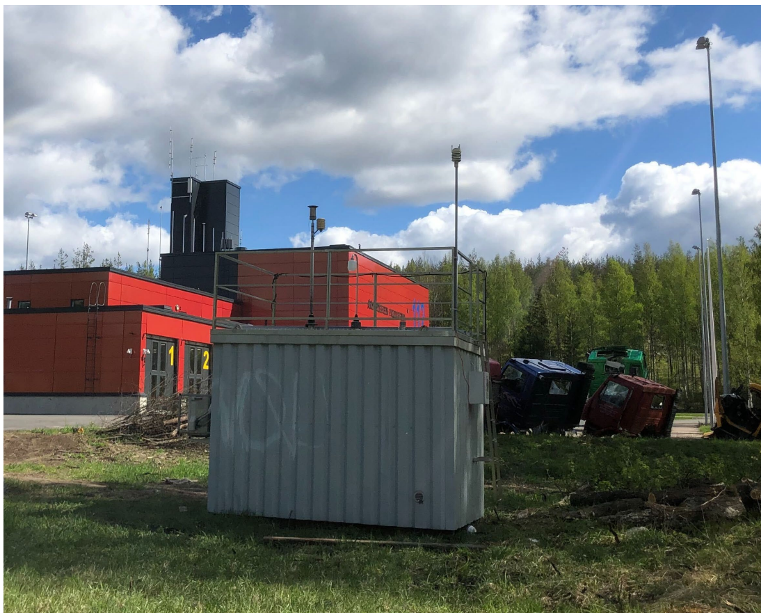
Kuva 19. Ilmanlaadun mittausasema Äänekosken paloaseman pihan laidalla. Ulkoilma imetään mittalaitteisiin kontin katolla sijaitsevien näytteenottimien läpi. Lisäksi katolla on säämittausanturi. Valokuva: Matias Saunamäki.
