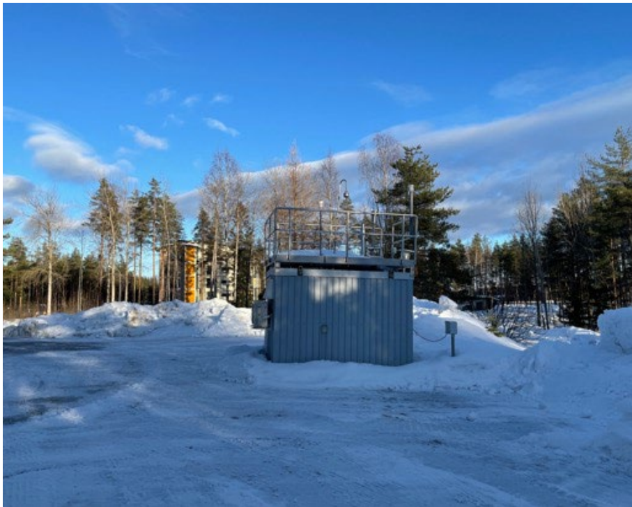
Kuva 30. Ilmanlaadun mittausasema Heinolan Vierumäellä Vierumäen koulun parkkipaikalla. Ulkoilma imetään mittalaitteisiin kontin katolla sijaitsevien näytteenottimien läpi. Lisäksi katolla on säämittausanturi. Valokuva: Matias Saunamäki.
