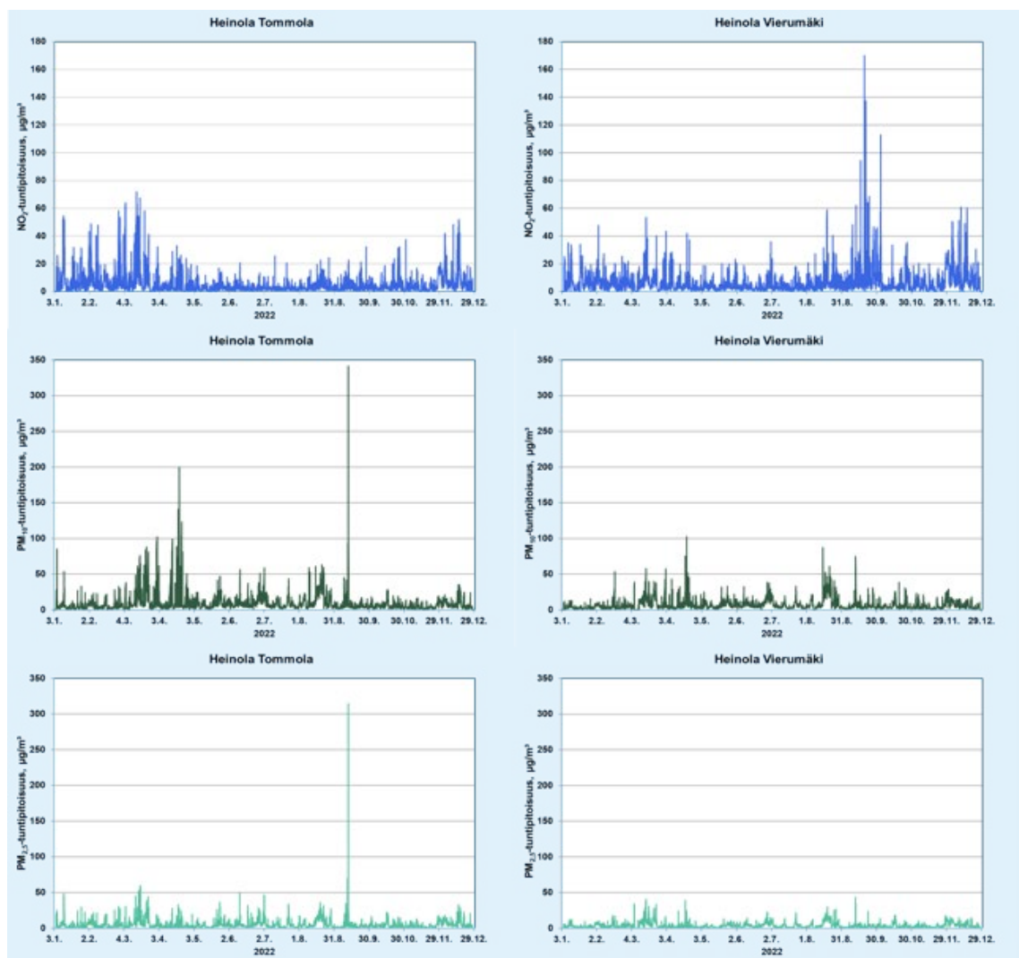
Kuva 1. Heinolan ilmanlaadun mittauspisteissä vuonna 2022 mitatut typpidioksidin (NO 2 ), hengitettävien hiukkasten (PM 10 ) ja pienhiukkasten (PM 2,5 ) tuntipitoisuudet.
