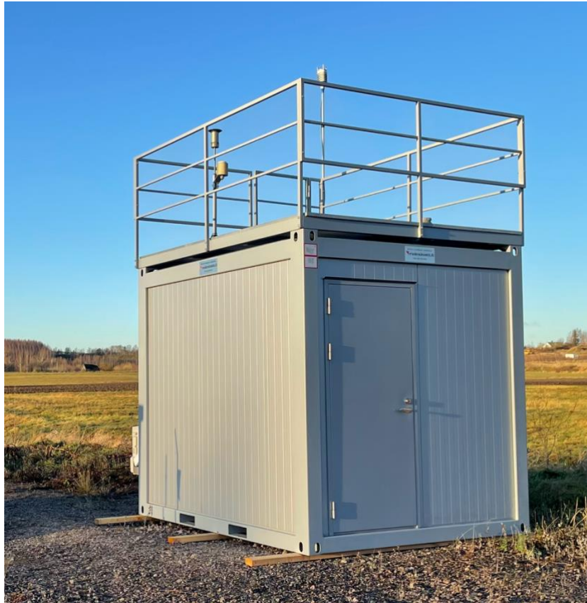
Kuva 12. Ilmanlaadun mittausasema Lappeenranta Ojala-Tuomela. Ulkoilma imetään mittalaitteisiin kontin katolla sijaitsevien näytteenottimien läpi. Lisäksi katolla on säänmittausanturi. Valokuva: Antti Mannisenaho.
