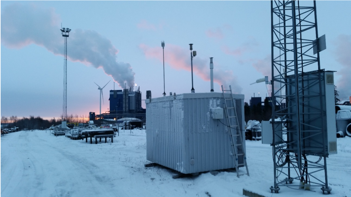
Kuva 29. Ilmanlaadun mittausyksikkö Tehdasalueen mittauspisteessä. Ulkoilma imetään mittauslaitteisiin mittausyksikön katolla sijaitsevien näytteenottosondien kautta.
