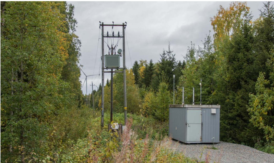
Kuva 30. Ilmanlaadun mittausyksikkö Puuluodon mittauspisteessä lähimmän asuinalueen vieressä.
